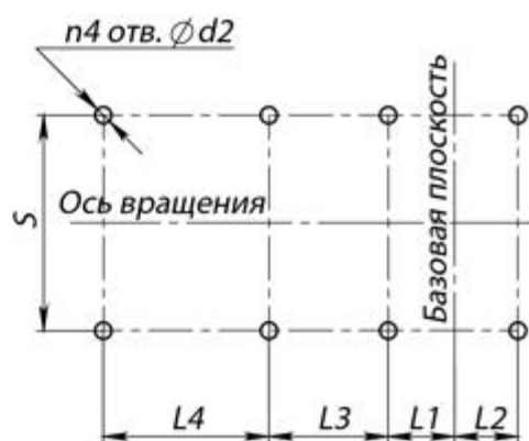
Схема расположения отверстий для крепления вентилятора
